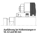
Ausführung bei Kolbenstangen- \varnothing 50, 63 und 80 mm
